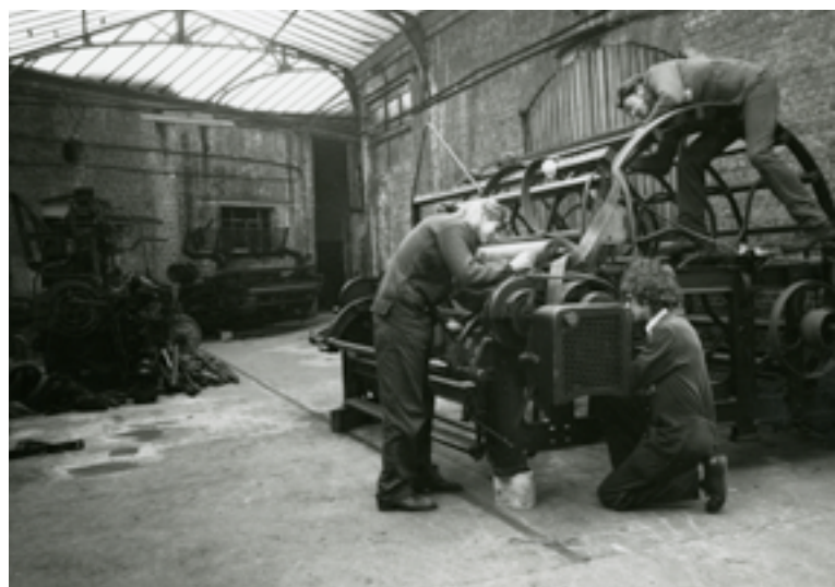
Museumvrijwilligers Georges, Danielle en Lisette bij de restauratie van de liggende scheermolen in de voormalige textiel fabriek Van den Broecke-Grenier aan de Bachtenwalle, Gent, eind jaren 1970.
